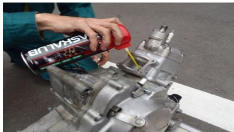
2ストロークエンジンのクランクケース、シリンダー組み込みにも(クラッチ側には使用しないで下さい)
